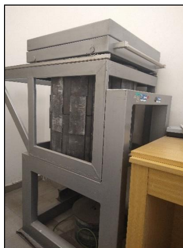
Obr. 4. Olověný kryt s 10cm olověným stíněním, uvnitř kterého je umístěn NaI(Tl) krystal
