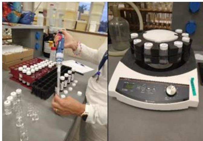
Obr. 6. Příprava vzorků pro stanovení Rn-222 metodou LSC (pipetování vzorku vody do scintilační lahvičky s 5 ml scintilátoru Opti-Fluor O; protřepání obsahu lahviček před měřením)
