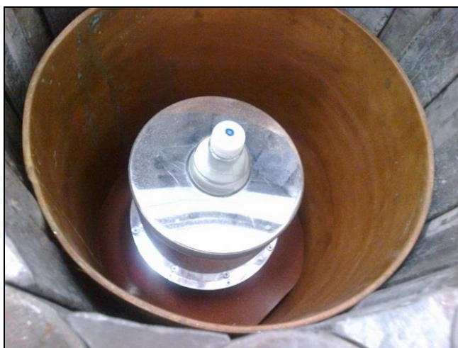
Obr. 3. Studnový NaI(Tl) krystal s PET vzorkovnicí 340 ml vloženou do „studny“ detektoru
